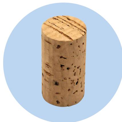
Bouchon en liège naturel. Les rainures sur la coupe et les orifices sur le corps sont les lenticelles, formées par les cernes de croissance de l'écorce du chêne-liège.
